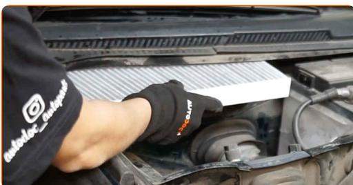
Suivez la direction de la flèche montrant la direction de l'air sur le filtre.
