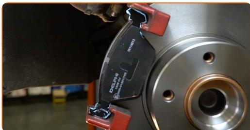
**31** Installez l'étrier de frein et fixez-le. Utilisez la clé HEX n° H7. Utilisez une clé dynamométrique. Serrez-le jusqu'à 30 Nm.
