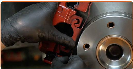
**34** Traitez les attaches du roulement de moyeu de roue. Utilisez de la graisse au cuivre.
