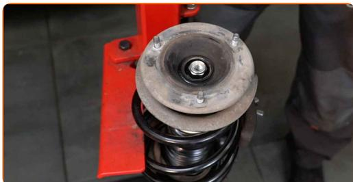
**51** Serrez l'écrou de l'entretoise d'amortisseur due la tige de piston. Utilisez une douille n° 22. Utilisez la clé HEX n° H6. Utilisez une clé dynamométrique. Serrez-le jusqu'à 64 Nm.
