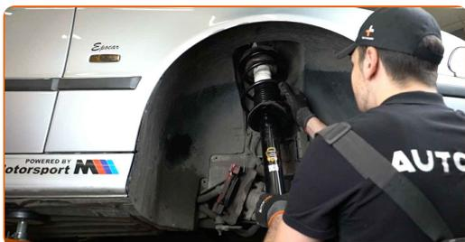
**55** Vissez l'attache supérieure du support de l'amortisseur. Ne serrez pas trop.
