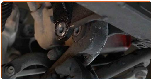
**34** Nettoyez les fixations assurant la connexion entre la jambe d'amortisseur et le porte-fusée. Utilisez une brosse métallique. Servez vous de l'aérosol WD-40.
