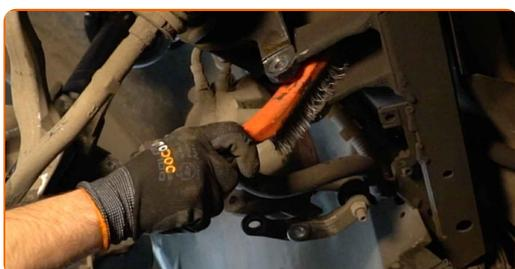
**62** Installez la fixation arrière du bras de commande.
