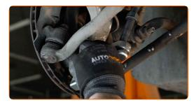
Dévissez la fixation inférieure assurant la connexion entre la jambe d'amortisseur et le porte-fusée. Utilisez une clé mixte de No.18 Utilisez une douille n° 16. Utilisez une clé à cliquet.
