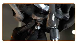
Vissez les fixations de la rotule. Utilisez une douille n° 22. Utilisez une clé à cliquet.
