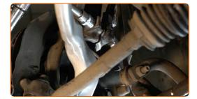
Serrez la fixation avant reliant le bras de commande au sous-châssis. Utilisez une clé mixte de No.18 Utilisez une douille n° 18. Utilisez une clé dynamométrique. Serrez-le jusqu'à 110 Nm.
