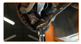
Serrez les fixations inférieures qui relient l'amortisseur à la fusée d'essieu. Utilisez une clé mixte de No.18 Utilisez une douille n° 16. Utilisez une clé dynamométrique. Serrez-le jusqu'à 81 Nm.
