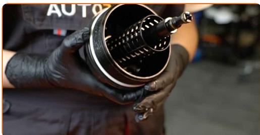
**16** Installez les nouveaux filtres à huile sur les sièges de montage sur le couvercle du filtre.
