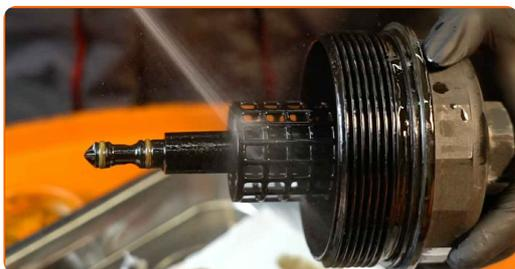
**15** Installez une nouvelle bague d'étanchéité sur l'emplacement du filtre à huile.
