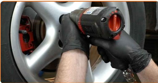
44 Abaissez la voiture et serrez les boulons de roue en ordre croisé. Servez-vous d'une douille à choc pour roue N°17. Utilisez une clé dynamométrique. Serrez-le jusqu'à 120 Nm.
