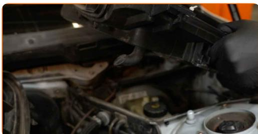
8 Dévissez le bouchon du réservoir de liquide de frein.
