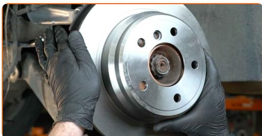
29 Serrez l'attache du disque de frein. Utilisez la clé HEX n° H6. Utilisez une clé dynamométrique. Serrez-le jusqu'à 16 Nm.
