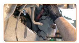
Dévissez l'attache du support d'étrier. Utilisez une douille n° 16. Utilisez un porte-taraud.
