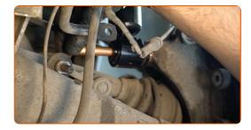
Serrez l'attache inférieure de l'amortisseur. Utilisez une douille n° 21. Utilisez une clé dynamométrique. Serrez-le jusqu'à 127 Nm.
