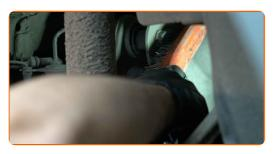
Débranchez les fils du capteur d'ABS.
