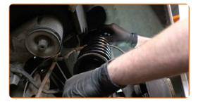
Vissez l'attache supérieure du support de l'amortisseur. Ne serrez pas trop.
