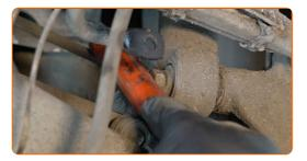
Dévissez l'attache inférieure du support de l'amortisseur. Utilisez une douille n° 21. Utilisez un porte-taraud.
