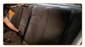
Vissez les fixations du dossier du siège arrière. Utilisez une douille n° 10. Utilisez une clé à cliquet.
