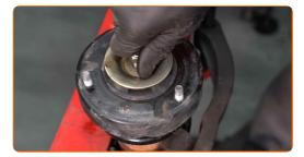
Serrez l'écrou de l'entretoise d'amortisseur due la tige de piston. Servez-vous d'un embout d'amortisseur DDNº6. Utilisez une douille n° 16. Utilisez une clé dynamométrique. Serrez-le jusqu'à 27 Nm.
