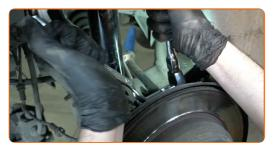
Serrez la fixation reliant le bras de suspension à l'essieu arrière. Utilisez une douille n° 22. Utilisez une clé dynamométrique. Serrez-le jusqu'à 142 Nm.
