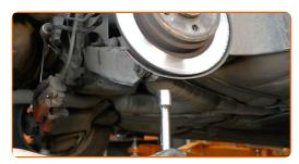
Vissez la fixation reliant le bras de commande au sous-châssis. Utilisez une clé mixte de No.16
