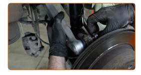
Vissez la fixation reliant le bras de commande à la fusée arrière. Utilisez une clé mixte de No.22 Utilisez une douille n° 10. Utilisez une clé à cliquet.
