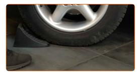
Desserrez les boulons de fixation de la roue. Servez-vous d'une douille à choc pour roue N°17. 16
