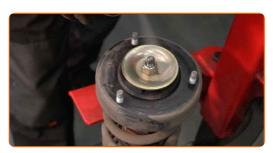
Retirez l'écrou de la tige de piston de l'entretoise. Servez-vous d'un embout d'amortisseur DDNº6. Utilisez une douille n° 16. Utilisez une clé à cliquet.
