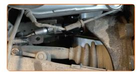
Serrez l'attache entre le bras et la barre. Utilisez une douille n° 16. Utilisez une clé dynamométrique. Serrez-le jusqu'à 110 Nm.
