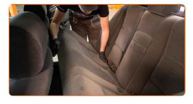
Dévissez les fixations du dossier du siège arrière. Utilisez une douille n° 10. Utilisez une clé à cliquet.
