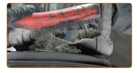
Dévissez la fixation reliant le bras de contrôle à l'essieu arrière. Utilisez une clé mixte de No.22 Utilisez une douille n° 10. Utilisez une clé à cliquet.
