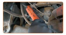
Dévissez la fixation reliant la biellette à la barre stabilisatrice. Utilisez une clé mixte de No.16 Utilisez une douille n° 16. Utilisez une clé à cliquet.
