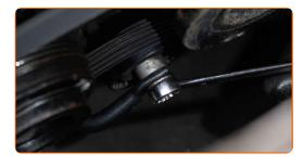
Retirez la courroie trapézoïdale.
