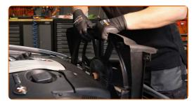
Écartez le galet tendeur de la courroie trapézoïdale. Utilisez une clé mixte de No.16
