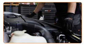
Retirez les clips du capot du ventilateur. Utilisez un outil d'extraction de clips.
