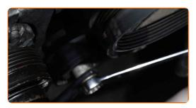
Mettez de côté la poulie de tendeur de la courroie en V crantée. Utilisez une clé mixte de No.24
