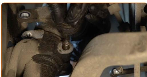
**37** Relâchez la fixation inférieure assurant la connexion entre la jambe d'amortisseur et le porte-fusée. Servez-vous d'un burin plat pour l'usinage des métaux. Servez-vous d'un marteau.
