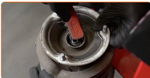
**46** Retirez l'écrou de la tige de piston de l'entretoise. Utilisez une douille n° 21. Utilisez la clé HEX n° H7. Utilisez une clé à cliquet.
