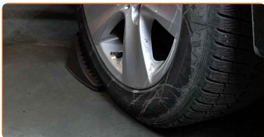
8 Desserrez les boulons de fixation de la roue. Servez-vous d'une douille à choc pour roue N°17.
