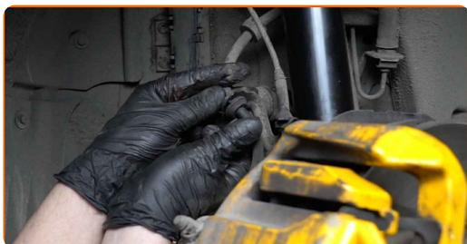
**91** Serrez les fixations du capteur de niveau de phare. Utilisez une douille n° 10. Utilisez une clé dynamométrique. Serrez-le jusqu'à 7 Nm.
