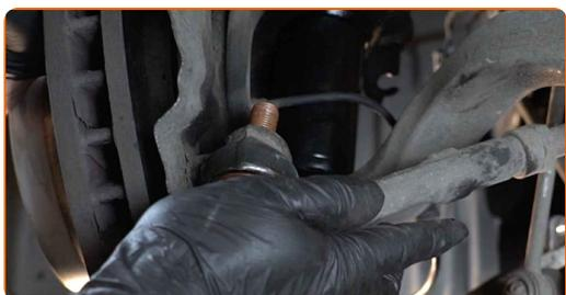
**80** Vissez l'écrou de fixation reliant l'embout de biellette à la fusée d'essieu. Utilisez une clé mixte de No.21 Utilisez la mèche Torx T40. Utilisez une clé à cliquet.
