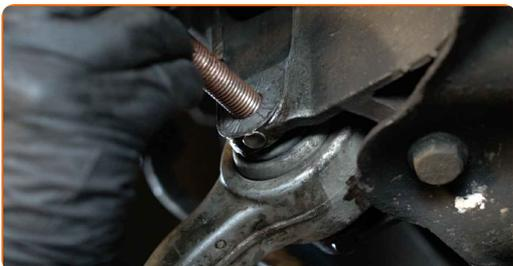
**76** Vissez la fixation arrière reliant le bras de suspension au cadre auxiliaire. Utilisez une clé mixte de No.18 (2 pièces).
