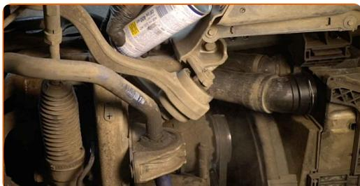
**22** Dévissez l'écrou d'attache d'extrémité à la fusée d'essieu. Utilisez une clé mixte de No.21 Utilisez la mèche Torx T40. Utilisez une clé à cliquet.
