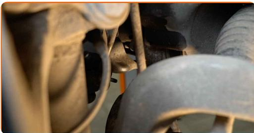
**16** Nettoyez les fixations assurant la connexion entre la jambe d'amortisseur et le porte-fusée. Nettoyez les fixations des stabilisateurs. Utilisez une brosse métallique. Servez vous de l'aérosol WD-40.
