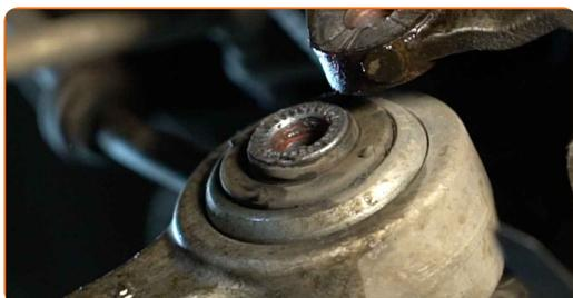
**33** Retirez la fixation avant du bras de suspension. Utilisez une clé mixte de No.18
