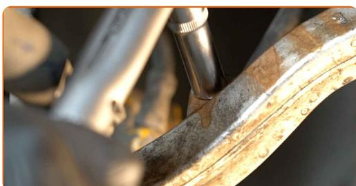
**92** Serrez la fixation reliant la biellette à l'amortisseur. Utilisez une douille n° 16. Utilisez une clé dynamométrique. Serrez-le jusqu'à 65 Nm.
