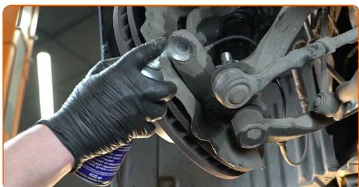
**79** Connectez l'extrémité du tirant à la fusée d'essieu.
