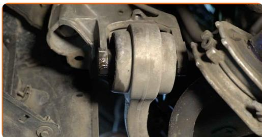
**35** Nettoyez les fixations assurant la connexion entre la jambe d'amortisseur et le porte-fusée. Utilisez une brosse métallique. Servez vous de l'aérosol WD-40.
