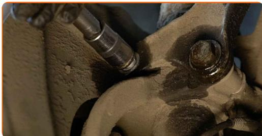
**20** Dévissez la fixation inférieure assurant la connexion entre la jambe d'amortisseur et le porte-fusée. Utilisez une clé mixte de No.18. Utilisez une douille n° 18. Utilisez une clé à cliquet.
