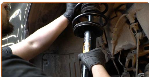
**64** Vissez l'attache supérieure du support de l'amortisseur. Ne serrez pas trop.
