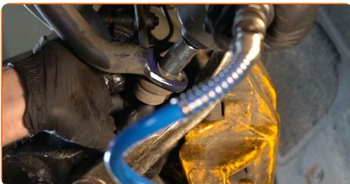
**8** Dévissez la fixation reliant la biellette à l'amortisseur. Utilisez une douille n° 16. Utilisez une clé à cliquet.
