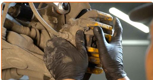
**27** Serrez le support de l'étrier de frein. Utilisez une douille n° 18. Utilisez une clé dynamométrique. Serrez-le jusqu'à 110 Nm.
