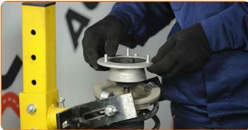
**42** Serrez l'écrou de l'entretoise d'amortisseur due la tige de piston. Utilisez une douille n° 22. Utilisez la clé HEX n° H6. Utilisez une clé dynamométrique. Serrez-le jusqu'à 64 Nm.
