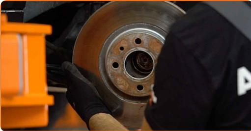
**15** Nettoyez le moyeu. Utilisez une brosse métallique. Traitez la surface de contact. Utilisez de la graisse au cuivre.
