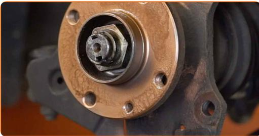
**16** Nettoyez la graisse anti-corrosion du nouveau disque de frein.
