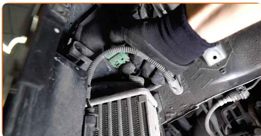
**11** Dévissez la fixation reliant le pare-chocs aux garde-boues. Utilisez la mèche Torx T30. Utilisez une clé à cliquet.
