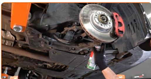
14.1 Installez une nouvelle barre, serrez les attaches.
