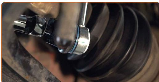
14.2 Servez vous de la clé polygonale n°18. Utilisez une douille n° 18. Utilisez la clé HEX n° H5. Utilisez une clé dynamométrique. Serrez-le jusqu'à 55 Nm.
