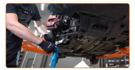
Connectez l'attache du câble du capteur ABS de l'entretoise de support de l'amortisseur. Attachez le tuyau de frein à l'entretoise.
