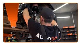
Nettoyez le siège de fixation de la jante. Utilisez une brosse métallique. Traitez la surface de contact. Utilisez de la graisse au cuivre.
