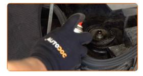
Dévissez l'attache supérieure du support de l'amortisseur. Utilisez une clé mixte de No.19. Utilisez la clé HEX n° 6 H7. Utilisez une clé à cliquet.
