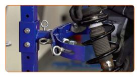
Installez l'entretoise de l'amortisseur dans l'arche de roue. Serrez l'écrou de fixation supérieur de l'entretoise de l'amortisseur. Ne serrez pas trop.
