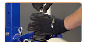
Serrez l'écrou de l'entretoise d'amortisseur due la tige de piston. Servez vous de la clé polygonale n°27. Utilisez la clé HEX n° H7. Utilisez une clé dynamométrique. Serrez-le jusqu'à 60 Nm.
