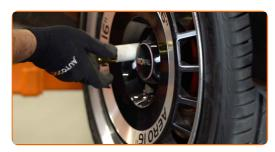
Serrez le montant supérieur de l'entretoise d'amortisseur. Utilisez une clé mixte de No.19. Utilisez la clé HEX n° H7. Utilisez une clé dynamométrique. Serrez-le jusqu'à 50 Nm.
