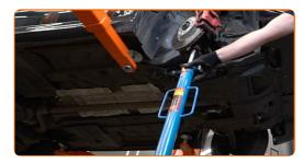
Dévissez la fixation inférieure assurant la connexion entre la jambe d'amortisseur et le porte-fusée. Servez vous de la clé polygonale n°17. Utilisez une douille n° 15. Utilisez une clé à cliquet.
