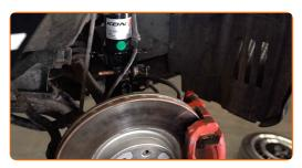
Serrez les fixations inférieures qui relient l'amortisseur à la fusée d'essieu. Utilisez une douille n° 15. Servez vous de la clé polygonale n°17. Utilisez une clé dynamométrique. Serrez-le jusqu'à 85 Nm.
