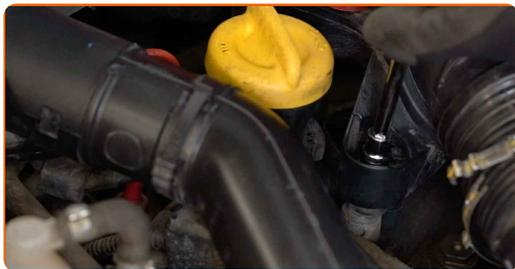
**37** Connectez le tuyau d'admission d'air au boîtier du filtre à air.
