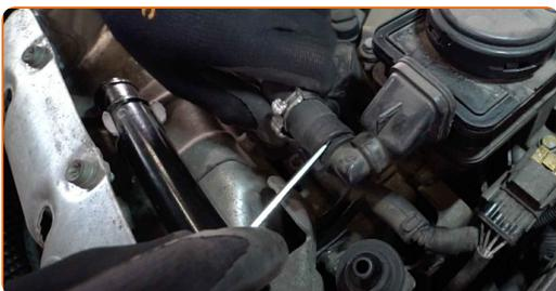
**13** Débranchez le connecteur du capteur de position d'arbre à cames.
