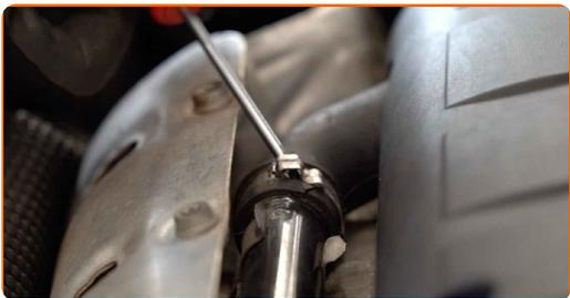
**5** Dévissez les attaches du cache moteur. Utilisez une douille n° 10. Utilisez une clé à cliquet.
