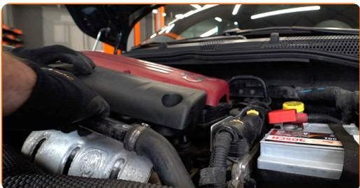
**8** Séparez le tuyau de ventilation du carter du conduit de ventilation.
