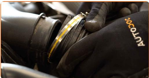
**7** Retirez le cache moteur avec le boîtier du filtre à air.
