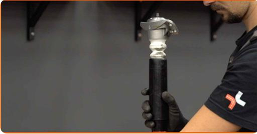
18 Fixez le support de l'amortisseur. Utilisez une clé mixte de No.14. Utilisez une douille n° 14. Utilisez une clé dynamométrique. Serrez-le jusqu'à 25 Nm.
