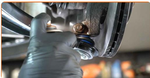
**30** Appliquez du produit sur la zone de contact entre le disque de frein et la jante. Utilisez du lubrifiant céramique à haute température.
