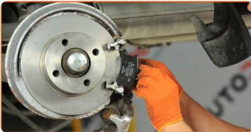
Remplacement : plaquettes de frein – Audi 80 B4. AUTODOC recommande :
