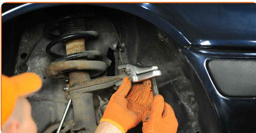
10 Déserrez l'écrou de blocage qui retient l'extrémité de la barre stabilisatrice à la barre stabilisatrice. Utilisez une clé mixte de No.14 Utilisez une clé mixte de No.22
