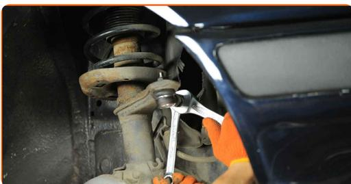
17 Appliquez du produit sur toutes les connexions de l'embout de biellette de direction. Utilisez de la graisse au cuivre.
