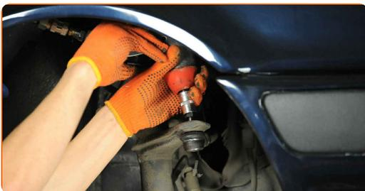
16 Serrez l'écrou de blocage de l'extrémité de la barre. Utilisez une clé mixte de No.14 Utilisez une clé mixte de No.22 Utilisez une clé dynamométrique. Serrez-le jusqu'à 40 Nm.
