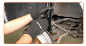
Installez les boulons de fixation.
