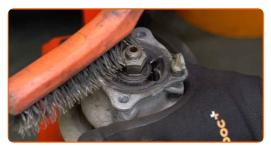
Retirez l'écrou de la tige de piston de l'entretoise. Utilisez une clé mixte de No.21 Utilisez la clé HEX n° H6. Utilisez une clé à cliquet.
