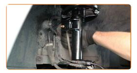
Serrez la fixation reliant la biellette à l'amortisseur. Utilisez une douille n° 16. Utilisez une clé dynamométrique. Serrez-le jusqu'à 55 Nm.
