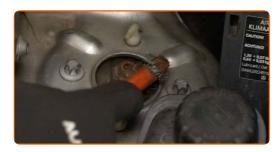
Desserrez les fixations supérieures de la jambe de suspension. Utilisez une douille n° E12. Utilisez une clé à cliquet.
