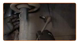
Débranchez les fils du capteur d'ABS.
