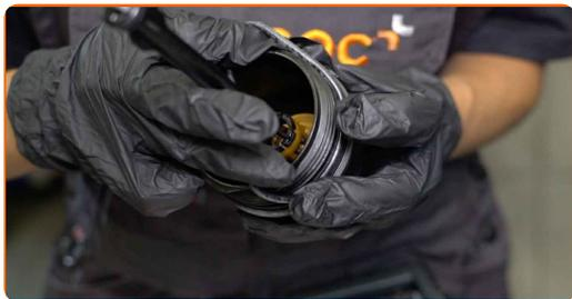
**17** Installez les nouveaux filtres à huile sur les sièges de montage sur le couvercle du filtre.
