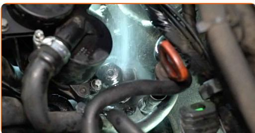
**6** Dévissez le bouchon du compartiment du filtre, ainsi que l'ancien élément filtrant. Utilisez une douille n° 32. Utilisez une clé à cliquet.
