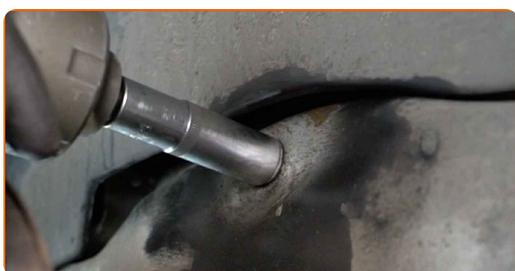
**22** Serrez l'attache de l'amortisseur supérieur. Utilisez une douille n° 16. Utilisez une clé dynamométrique. Serrez-le jusqu'à 40 Nm.+90°
