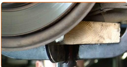
**21** Serrez la fixation supérieure de l'amortisseur. Utilisez une clé mixte de No.16 Utilisez une douille n° 16. Utilisez une clé à cliquet.
