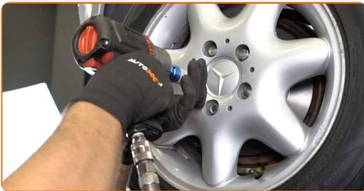
**32** Abaissez la voiture et serrez les boulons de roue en ordre croisé. Servez-vous d'une douille à choc pour roue N°17. Utilisez une clé dynamométrique. Serrez-le jusqu'à 110 Nm.
