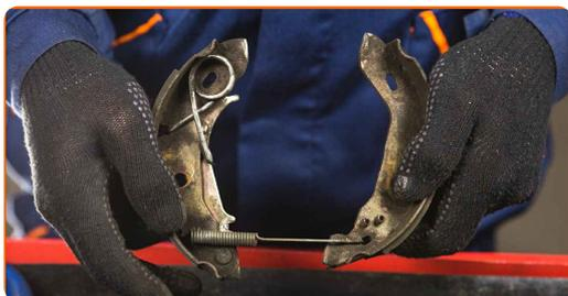
**20** Installez les ressorts de retenue supérieurs et le mécanisme de réglage sur les nouvelles mâchoires de frein.
