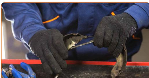
**19** Démontez maintenant le ressort de maintien supérieur ainsi que le mécanisme de réglage. Utilisez des pinces.
