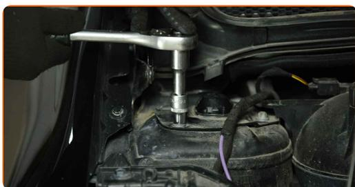
**18** Retirez le réservoir de liquide de refroidissement.
