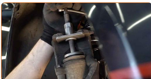
**33** Installez l'étrier de frein et fixez-le. Utilisez une clé mixte de No.13 Utilisez une clé mixte de No.15 Utilisez une clé dynamométrique. Serrez-le jusqu'à 35 Nm.
