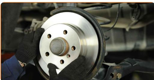
**22** Serrez l'attache du disque de frein. Utilisez la mèche Torx T30. Utilisez une clé dynamométrique. Serrez-le jusqu'à 9 Nm.
