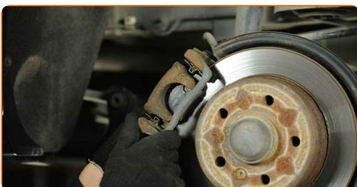
Remplacement : disques de frein – Mercedes W169. AUTODOC recommande :
