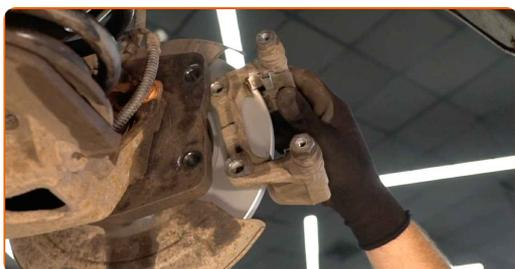
**29** Serrez le support de l'étrier de frein. Utilisez une clé mixte de No.16 Utilisez une clé dynamométrique. Serrez-le jusqu'à 55 Nm.
