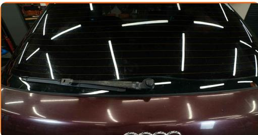
7 Après installation, vérifiez la performance des essuie-glaces. Les balais ne doivent pas s'entrechoquer ni cogner contre le joint du pare-brise.
