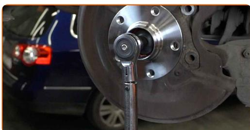
**Remplacement : roulement de roue – Audi A3 8PA. Conseil :**
