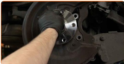
**24** Serrez le moyeu. Servez vous de la douille XZN n°16. Utilisez une clé dynamométrique. Serrez-le jusqu'à 180 Nm.+180°
