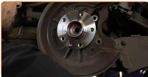
**23** Installez l'écrou de fixation.
