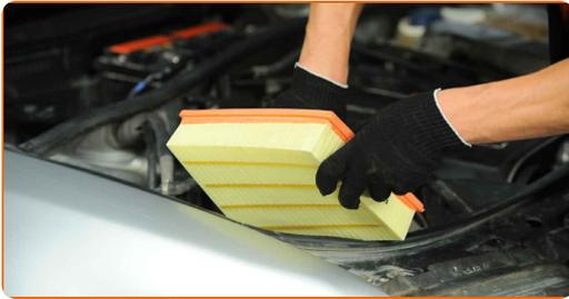
**Remplacement : filtre à air – Audi A4 B5 Avant. Les professionnels recommandent :**
