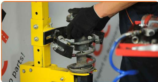
Remplacement : coupelle d'amortisseur – Audi A4 B5 Avant. Les professionnels recommandent :
