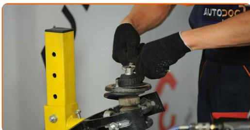
Remplacement : coupelle d'amortisseur – Audi A4 B5 Avant. AUTODOC recommande :
