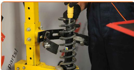
**33** Installez le support supérieur de l'amortisseur qui est monté avec les bras de commande.
