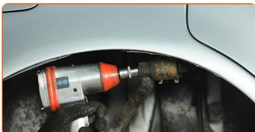
**16** Retirez l'écrou de fixation.
