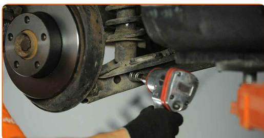
**8** Retirez l'écrou de fixation.
