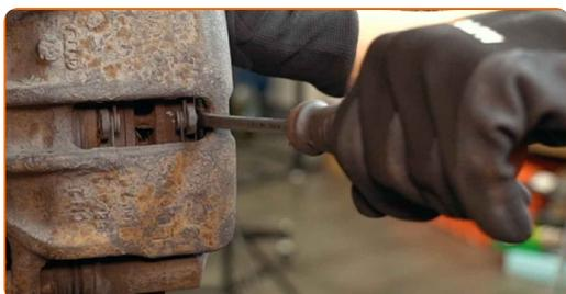
**8** Débranchez les fils du capteur d'ABS.
