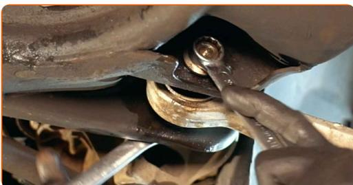
**65** Installez l'écrou de fixation.
