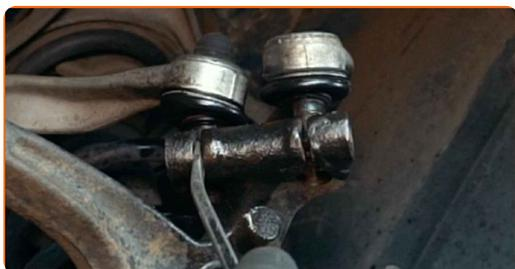
**30** Détachez l'arbre de transmission de la fusée d'essieu.
