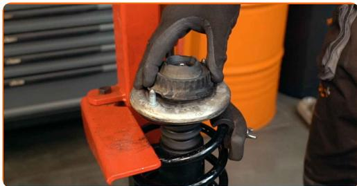
**45** Serrez l'écrou de l'entretoise d'amortisseur due la tige de piston. Utilisez la clé HEX n° H6. Utilisez une douille n° 18. Utilisez une clé dynamométrique. Serrez-le jusqu'à 50 Nm.
