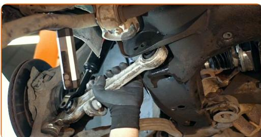
**63** Installez l'écrou de fixation.
