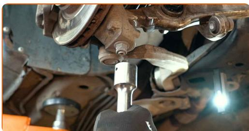
**68** Serrez l'attache inférieure de l'amortisseur. Utilisez une clé mixte de No.18. Utilisez une douille n° 18. Utilisez une clé dynamométrique. Serrez-le jusqu'à 90 Nm.
