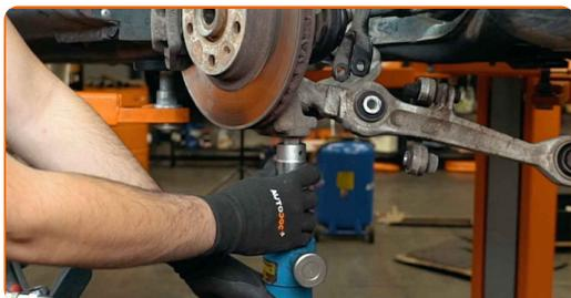
**28** Retirez l'écrou de fixation.
