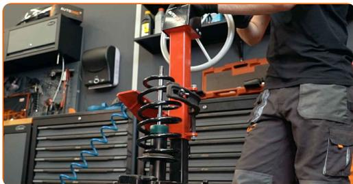
**44** Installez la coupelle, le manchon et la butée de suspension sur l'amortisseur.
