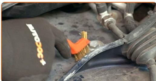
**6** Desserrez les fixations supérieures de la jambe de suspension. Utilisez une douille n° 16. Utilisez une clé à cliquet.
