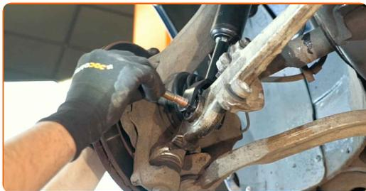
**66** Vissez la fixation inférieure de la jambe d'amortisseur. Utilisez une clé mixte de No.18. Utilisez une douille n° 18. Utilisez une clé à cliquet.
