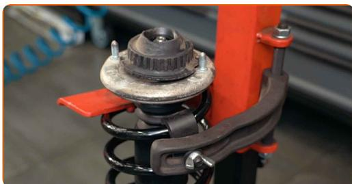
**47** Lubrifiez la barre d'amortisseur. Utilisez de la graisse au cuivre.
