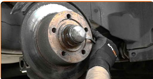
**16** Retirez la goupille fendue qui garde l'écrou du moyeu en place. Servez-vous d'un pied-de-biche. Utilisez un tournevis plat.
