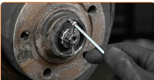
**17** Dévissez l'écrou de moyeu. Utilisez une douille n° 24. Utilisez un porte-taraud.
