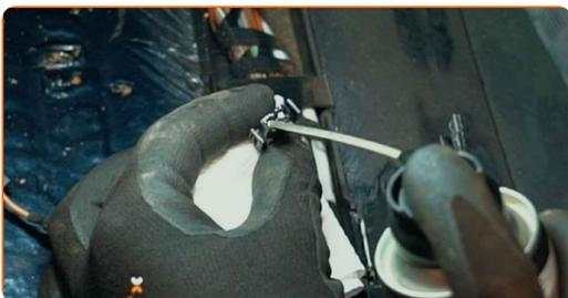
**49** Attachez le connecteur du capteur ABS.
