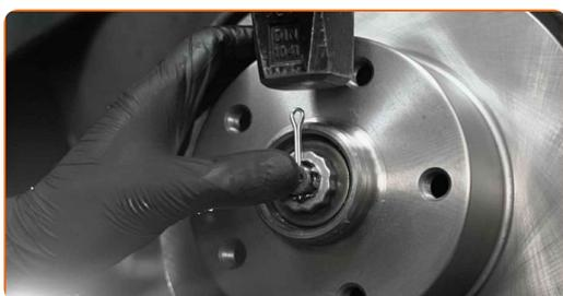
**36** Installez le bouchon de l'écrou du moyeu. Servez-vous d'un maillet en caoutchouc.
