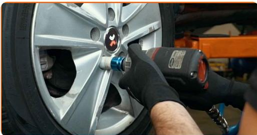
**46** Abaissez la voiture et serrez les boulons de roue en ordre croisé. Servez-vous d'une douille à choc pour roue N°17. Utilisez une clé dynamométrique. Serrez-le jusqu'à 120 Nm.
