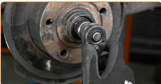
**18** Retirez le disque de frein qui est assemblé avec le palier de moyeu de roue. Servez-vous d'un pied-de-biche.
