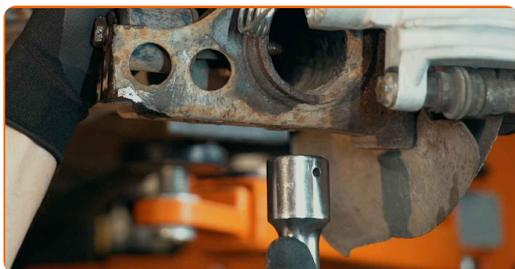
**15** Retirez l'écrou de fixation.
