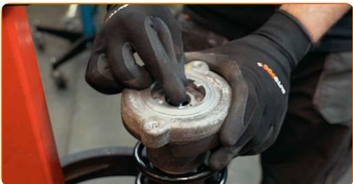
**33** Serrez l'écrou de l'entretoise d'amortisseur due la tige de piston. Utilisez une douille n° 16. Servez-vous d'un embout d'amortisseur DDN<sup>o</sup>5,2. Utilisez une clé dynamométrique. Serrez-le jusqu'à 25 Nm.
