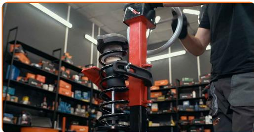
**35** Lubrifiez la barre d'amortisseur. Utilisez de la graisse au cuivre.
