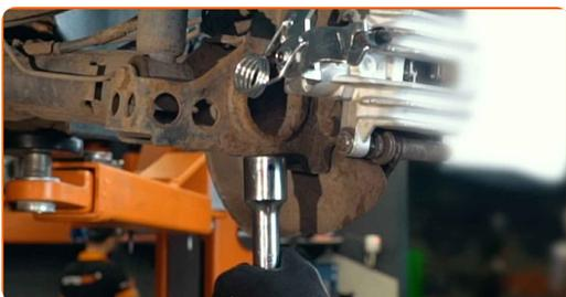
**12** Nettoyez la fixation inférieure reliant la jambe de suspension à la fusée d'essieu. Utilisez une brosse métallique. Servez vous de l'aérosol WD-40.
