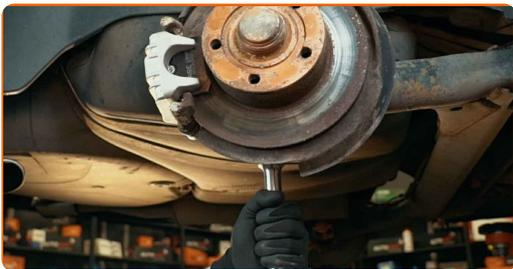
**44** Serrez l'attache inférieure de l'amortisseur. Utilisez une clé mixte de No.16. Utilisez une douille n° 16. Utilisez une clé dynamométrique. Serrez-le jusqu'à 50 Nm.+90°
