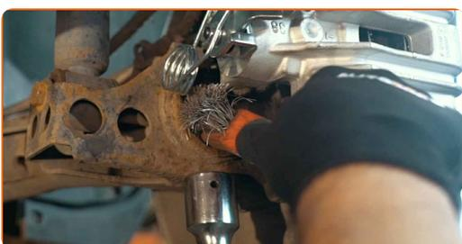
**13** Dévissez la fixation inférieure assurant la connexion entre la jambe d'amortisseur et le porte-fusée. Utilisez une clé mixte de No.16 Utilisez une douille n° 16. Utilisez une clé à cliquet.
