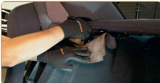
**5** Desserrez les fixations supérieures de la jambe de suspension. Utilisez une douille n° 13. Utilisez une clé à cliquet.
