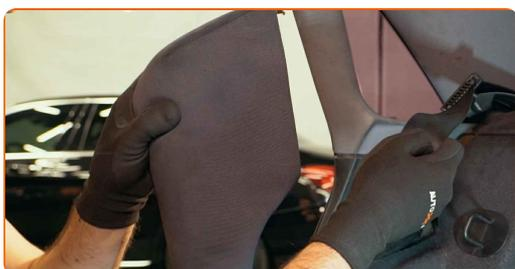
**3** Retirez le dispositif de retenue du panneau de garniture latéral. Utilisez un outil d'extraction de clips.
