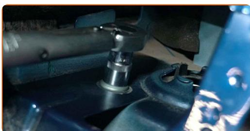
**55** Lubrifiez les fixations de la coupelle d'amortisseur. Utilisez de la graisse au cuivre.
