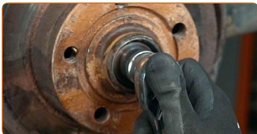
**17** Retirez le disque de frein qui est assemblé avec le palier de moyeu de roue. Servez-vous d'un pied-de-biche.
