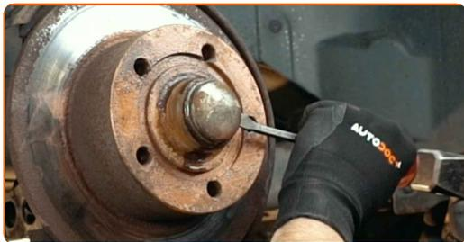
**15** Retirez la goupille fendue qui garde l'écrou du moyeu en place. Servez-vous d'un pied-de-biche. Utilisez un tournevis plat.
