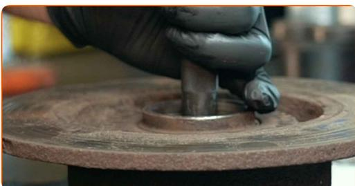
**21** Retirez la bague intérieure du roulement du moyeu de la roue. Retirez le joint à huile intérieur du roulement de la roue. Utilisez un extracteur universel. Servez-vous de l'extracteur de moyeu à inertie.
