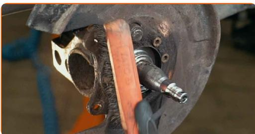
**20** Faites sortir le palier du moyeu de roue. Servez-vous d'un coffret de douilles et de roulements. Servez-vous d'un marteau.
