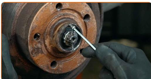
**16** Dévissez l'écrou de moyeu. Utilisez une douille n° 24. Utilisez un porte-taraud.
