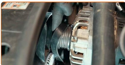
**15** Vissez la fixation de la poulie de tendeur de courroie du compresseur AC. Utilisez une clé mixte de No.17 Utilisez la clé HEX n° H7. Utilisez une clé à cliquet.
