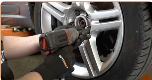
**76** Abaissez la voiture et serrez les boulons de roue en ordre croisé. Servez-vous d'une douille à choc pour roue N°17. Utilisez une clé dynamométrique. Serrez-le jusqu'à 120 Nm.
