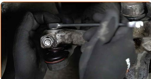
**16** Dévissez l'écrou d'attache d'extrémité à la fusée d'essieu. Utilisez une douille n° 15. Utilisez une clé à cliquet.
