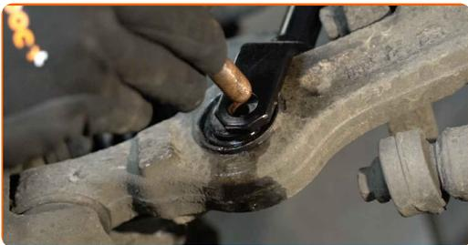
**51** Vissez la fixation reliant la jambe de suspension au bras de commande. Utilisez une clé mixte de No.18 (2 pièces).
