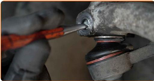
**18** Déconnectez l'extrémité de la barre de la fusée d'essieu. Servez-vous d'un burin plat pour l'usinage des métaux. Servez-vous d'un marteau.
