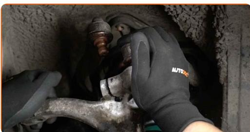
**55** Installez l'écrou de fixation.
