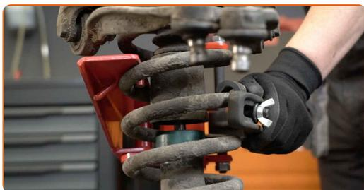
**32** Retirez l'écrou de la tige de piston de l'entretoise. Utilisez une douille n° 18. Utilisez la clé HEX n° H5. Utilisez une clé à cliquet.
