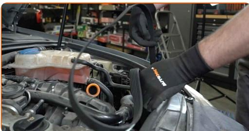
**Remplacement : courroie poly V – Audi A4 B7. AUTODOC recommande :**
