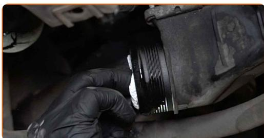
**46** Détachez le collier de serrage de la durite d'admission d'air. Utilisez une douille n° 7. Utilisez une clé à cliquet.
