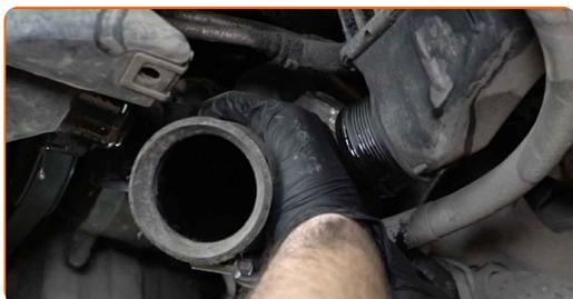
**45** Couvrez le conduit d'air du refroidisseur intermédiaire avec un chiffon en microfibre pour empêcher la saleté et les corps étrangers de pénétrer dans le système.
