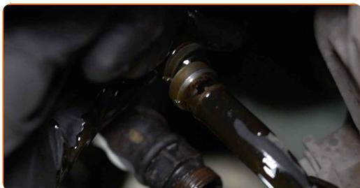
**54** Nettoyez le tuyau de la conduite de refroidissement du fluide de la transmission automatique. Utilisez une brosse métallique. Servez-vous d'un aérosol nettoyant multi-usages.
