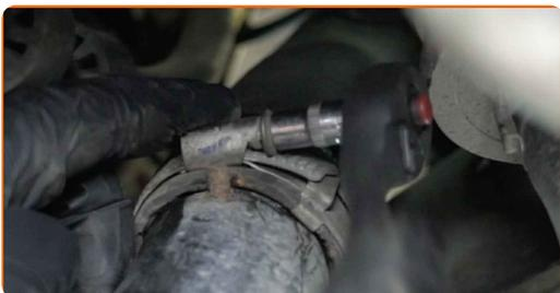
**170** Installez le câble de verrouillage du capot.
