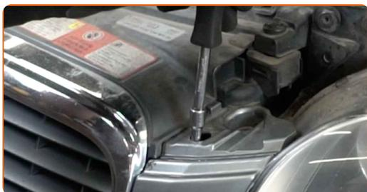
**209** Vissez la fixation de l'entretoise située sous la barre de renfort du pare-chocs. Utilisez la mèche Torx T25. Utilisez une douille n° 10. Utilisez une clé à cliquet.
