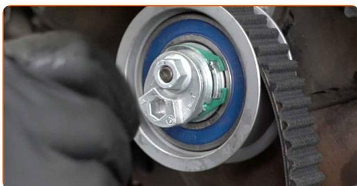
**117** Appliquez du produit sur les boulons de serrage. Utilisez un enduit.
