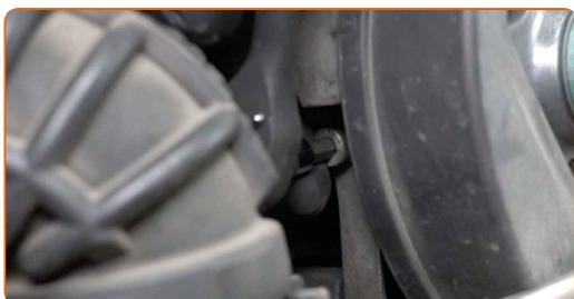
**83** Desserrez le collier de serrage du tuyau de refroidissement. Utilisez des pinces de clic-R.
