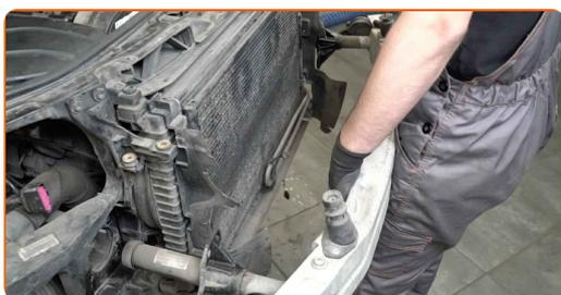
**33** Dévissez les fixations des conduits d'air du radiateur. Utilisez la mèche Torx T20. Utilisez une clé à cliquet.
