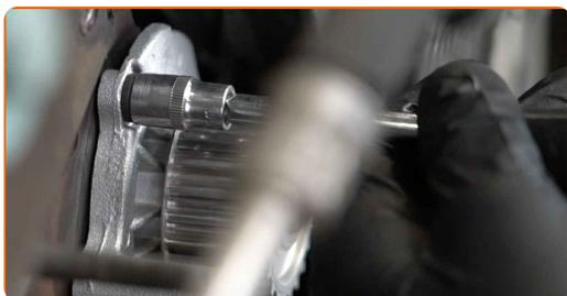
**112** Serrez les fixations de la pompe à eau. Utilisez une douille n° 10. Utilisez une clé dynamométrique. Serrez-le jusqu'à 15 Nm.
