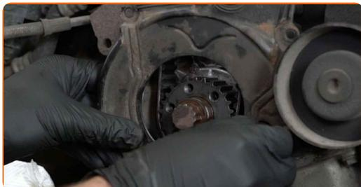
**130** Serrez les fixations du carter de distribution inférieur. Utilisez une douille n° 10. Utilisez une clé dynamométrique. Serrez-le jusqu'à 10 Nm.
