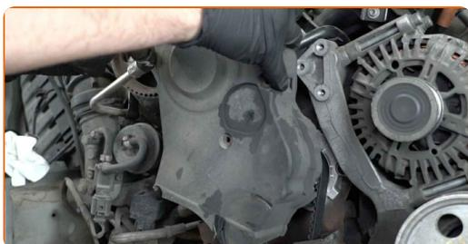
**132** Serrez les fixations du carter de la courroie de distribution. Utilisez une douille n° 10. Utilisez la mèche Torx T27. Utilisez une clé dynamométrique. Serrez-le jusqu'à 10 Nm.
