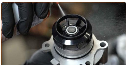
**109** Appliquez du produit sur l'emplacement de montage de la pompe à eau. Utilisez un enduit.
