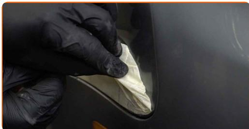
**208** Vissez les fixations reliant le pare-chocs aux ailes. Utilisez une douille n° 10. Utilisez une clé à cliquet.
