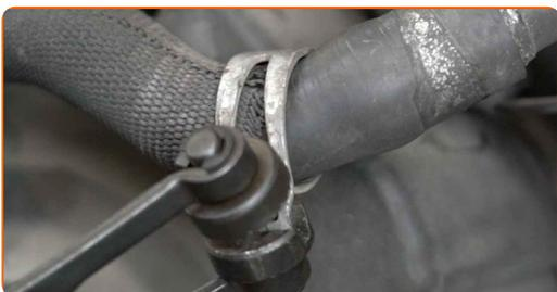
**135** Vissez la fixation du collier de serrage du tuyau de refroidissement. Utilisez la clé HEX n° H6. Utilisez une clé à cliquet.
