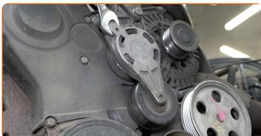
**80** Dévissez la fixation du galet tendeur de la courroie poly-V. Utilisez une douille n° 13. Utilisez une clé à cliquet.
