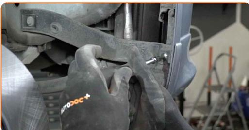
**13** Dévissez la fixation reliant le pare-chocs aux garde-boues. Utilisez une douille n° 10. Utilisez une clé à cliquet.
