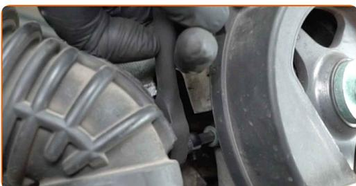
**136** Appliquez du produit sur les boulons de serrage. Utilisez un enduit.
