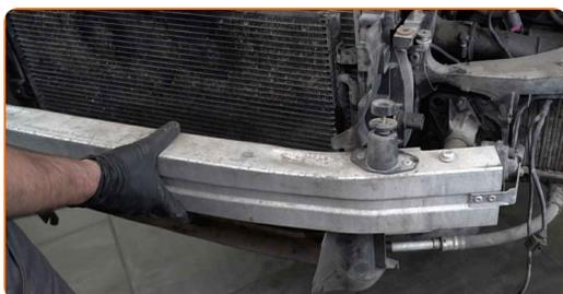
**179** Vissez les fixations de la barre de renforcement du pare-chocs. Utilisez une douille n° 13. Utilisez une clé à cliquet.
