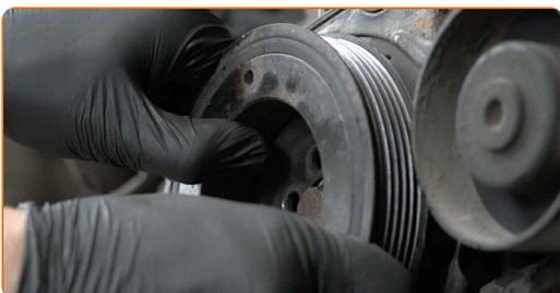
**92** Dévissez les fixations du carter de distribution inférieur. Utilisez une douille n° 10. Utilisez une clé à cliquet.
