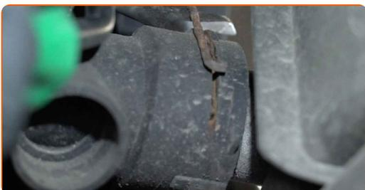
**43** Détachez le collier de serrage de la durite d'admission d'air. Utilisez une douille n° 7. Utilisez une clé à cliquet.
