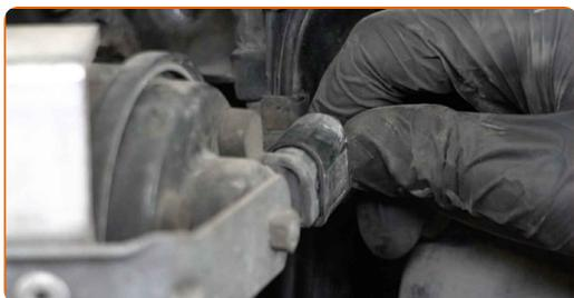
**189** Attachez le câblage du capteur de température du liquide de refroidissement.
