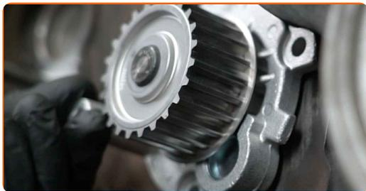
**111** Vissez les fixations de la pompe à eau. Utilisez une douille n° 10. Utilisez une clé à cliquet.
