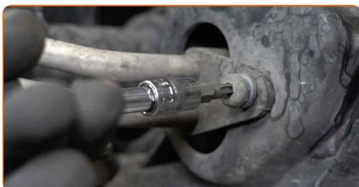
**36** Détachez les tuyaux de la direction assistée hydraulique.
