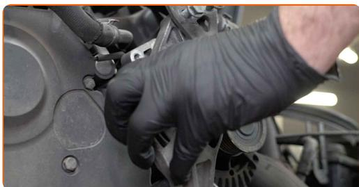
**82** Dévissez la fixation du collier de serrage du tuyau de refroidissement. Utilisez la clé HEX n° H6. Utilisez une clé à cliquet.
