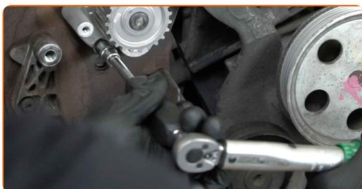
**113** Installez la nouvelle courroie de distribution conformément aux repères de calage.
