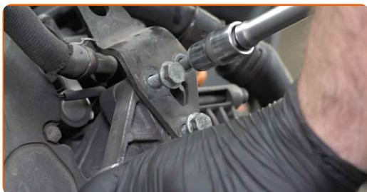
**81** Retirez le galet tendeur de la courroie poly-V.
