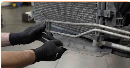
**35** Dévissez les fixations des tuyaux de la direction assistée hydraulique. Utilisez la mèche Torx T20. Utilisez la mèche Torx T27. Utilisez une clé à cliquet.
