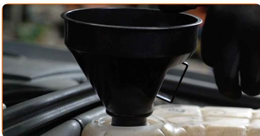
**220** Versez du liquide de refroidissement dans le réservoir.
