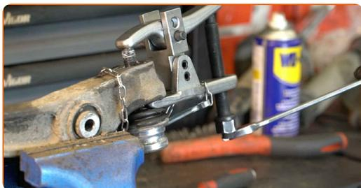
**21** Attachez le joint à rotule au bras de contrôle.
