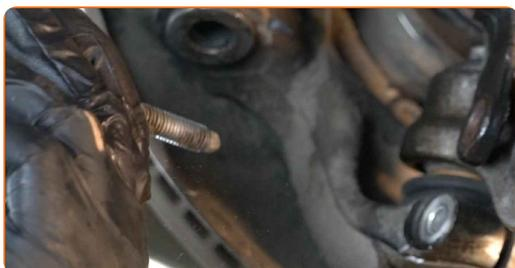
**16** Relâchez la fixation reliant le joint à rotule au porte-fusée. Servez-vous d'une douille spéciale pour retirer l'amortisseur. Utilisez une clé à cliquet.
