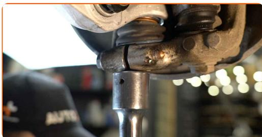
**33** Serrez l'attache du joint rotule. Utilisez une clé mixte de No.18 Utilisez une douille n° 18. Utilisez une clé dynamométrique. Serrez-le jusqu'à 110 Nm.
