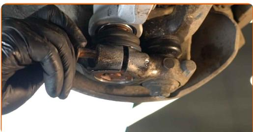
**31** Vissez les fixations de la rotule. Utilisez une douille n° 16. Utilisez une clé à cliquet.
