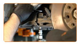
Retirez les écroux de fixations. Utilisez une douille n° E18. Utilisez une clé à cliquet.
