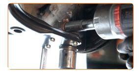
Vissez la fixation arrière reliant le bras de suspension au cadre auxiliaire. Utilisez une clé mixte de No.18. Utilisez une douille n° E18. Utilisez une clé à cliquet.
