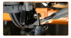
Dévissez l'attache du bras avant. Utilisez une douille n° E18. Utilisez un porte-taraud.
