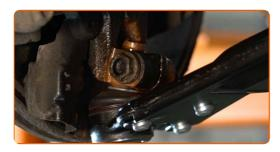
Vissez les fixations de la rotule. Utilisez une clé mixte de No.16. Utilisez une douille n° 16. Utilisez une clé à cliquet.
