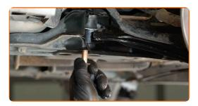
Vissez la fixation arrière reliant le bras de suspension au cadre auxiliaire. Utilisez une clé mixte de No.18. Utilisez une douille n° E18. Utilisez une clé à cliquet.
