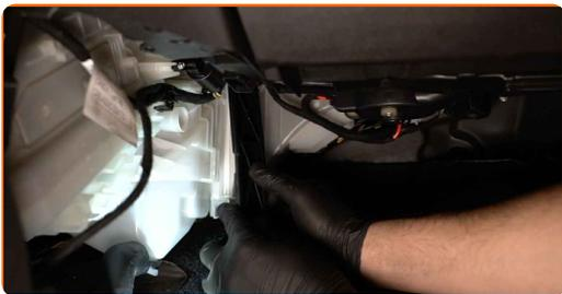
**10** Vissez les attaches du couvercle du boîtier du filtre d'habitacle. Utilisez la mèche Torx T25.
