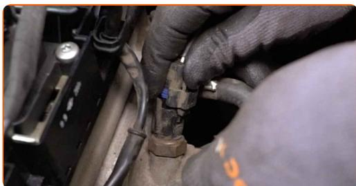
**28** Desserrez le collier de serrage du tuyau de refroidissement. Utilisez un tournevis plat.
