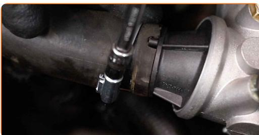
**50** Appliquez du produit sur le connecteur du capteur de température du liquide de refroidissement. Utilisez de la graisse diélectrique.
