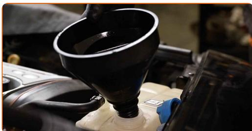
**69** Versez du liquide de refroidissement dans le réservoir.
