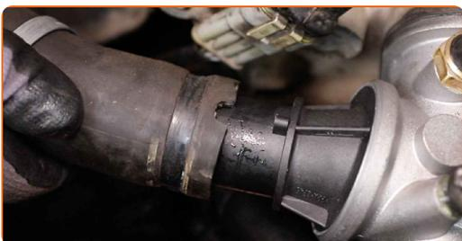
**49** Fixez le collier de serrage du tuyau de refroidissement. Utilisez une douille n° 7. Utilisez une clé à cliquet.
