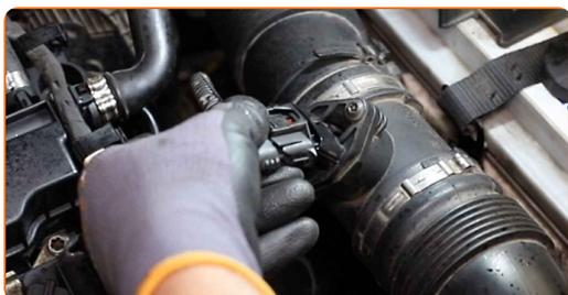
**60** Connectez le câblage du capteur de débit massique (MAF).
