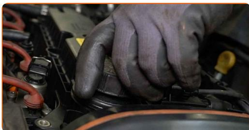
**18** Sur le côté droit, détachez le tuyau de la valve PCV du couvercle du moteur. Utilisez un tournevis plat.
