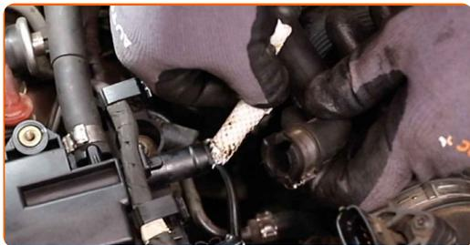
**57** Sur le côté droit, attachez le tuyau de la valve PCV au couvercle du moteur. Utilisez des pinces de clic-R.
