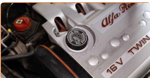
**66** Vissez les attaches du cache moteur. Utilisez la mèche Torx T40. Utilisez une clé à cliquet.
