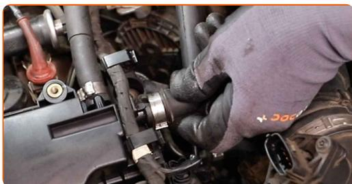
**58** Appliquez du produit sur le débitmètre. Utilisez de la graisse diélectrique.
