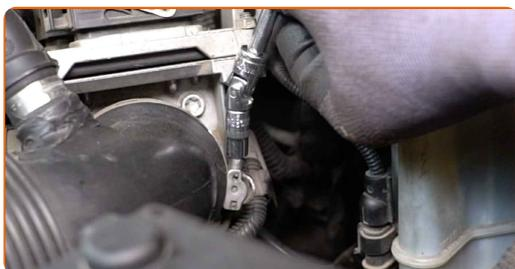
**23** Déconnectez le tuyau d'admission d'air du boîtier du filtre à air.
