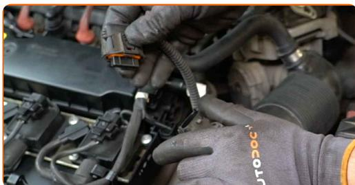
**21** Débranchez le câblage du capteur MAF. Utilisez un tournevis plat.
