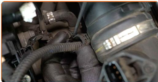
**22** Dévissez l'anneau de serrage et les fixations du tuyau d'admission du filtre à air. Utilisez une douille n° 7. Utilisez une clé à cliquet.
