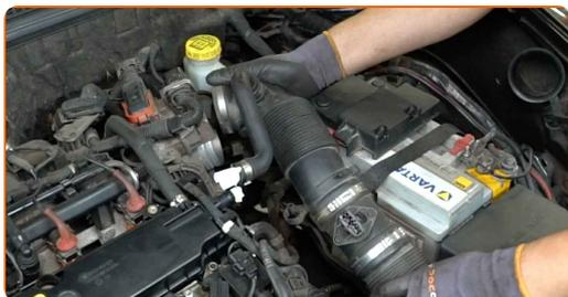
**24** Recouvrez le boîtier-papillon avec un chiffon microfibre pour empêcher que des particules n'entrent dans le système.
