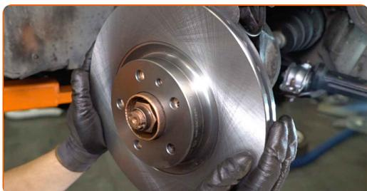
**21** Serrez l'attache du disque de frein. Utilisez une douille n° 12. Utilisez une clé dynamométrique. Serrez-le jusqu'à 11 Nm.
