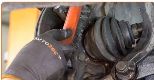
**14** Dévissez l'attache du support d'étrier. Utilisez une douille n° 19. Utilisez une clé à cliquet. Utilisez un porte-taraud.
