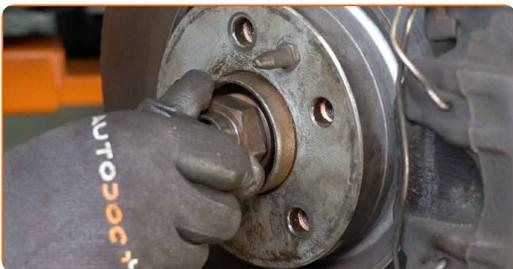
**49** Vissez l'écrou à l'arbre d'entraînement. Utilisez une douille n° 38. Utilisez une clé à cliquet.
