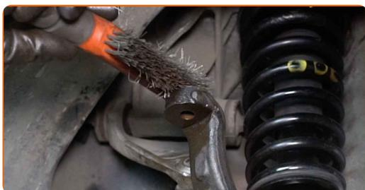
**31** Vissez la fixation reliant le bras de suspension à la fusée d'essieu. Utilisez une douille n° 17. Utilisez une clé à cliquet.
