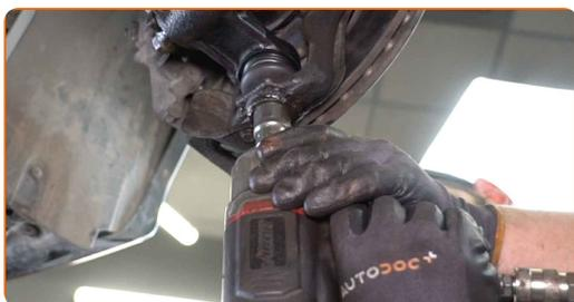
**40** Serrez la fixation connectant le joint à rotule à la fusée d'essieu. Utilisez une douille n° 24. Utilisez une clé dynamométrique. Serrez-le jusqu'à 90 Nm.
