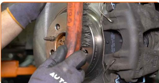
**55** Appliquez du produit sur la zone de contact entre le disque de frein et la jante. Utilisez de la graisse au cuivre.
