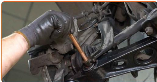
**37** Vissez la fixation reliant la fourchette d'amortisseur au bras de suspension inférieur. Utilisez une clé mixte de No.19 Utilisez une douille n° 19. Utilisez une clé à cliquet.
