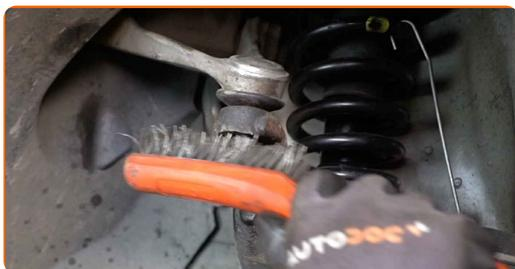
**38** Dévissez la fixation reliant le bras de suspension à la fusée d'essieu. Utilisez une douille n° 17. Utilisez une clé à cliquet.
