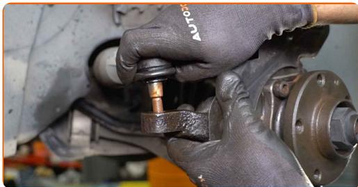
**74** Vissez l'écrou de fixation reliant l'embout de biellette à la fusée d'essieu. Utilisez une douille n° 17. Utilisez une clé à cliquet.
