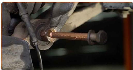
**76** Vissez la fixation reliant la fourchette d'amortisseur au bras de suspension inférieur. Utilisez une clé mixte de No.19 Utilisez une douille n° 19. Utilisez une clé à cliquet.
