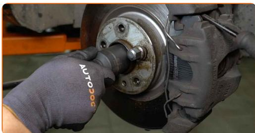
**10** Retirez l'écrou de fixation.
