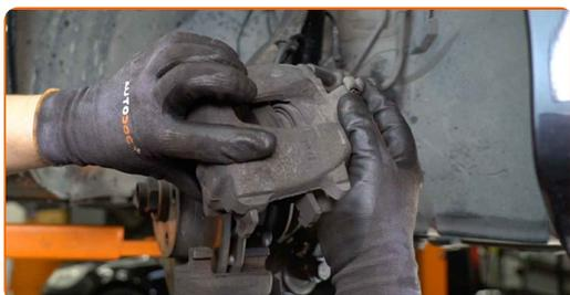
**96** Installez les bouchons anti-poussière des goupilles de guidage de l'étrier de frein.
