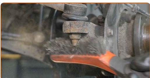
**35** Dévissez l'écrou d'attache d'extrémité à la fusée d'essieu. Utilisez une douille n° 17. Utilisez une clé à cliquet.
