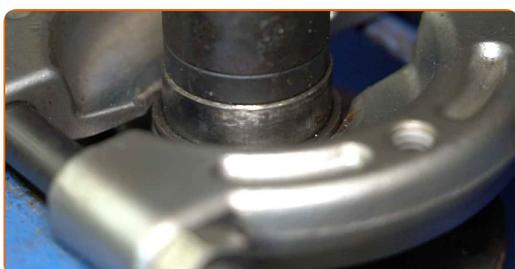
**55** Appliquez du produit sur le palier de moyeu de roue. Utilisez de la graisse au cuivre.
