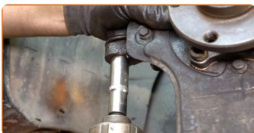
**75** Installez l'écrou de fixation.
