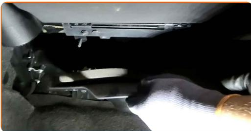
**5** Dévissez les attaches du couvercle du boîtier du filtre d'habitacle. Utilisez une douille n° 5.5. Utilisez une clé à cliquet.
