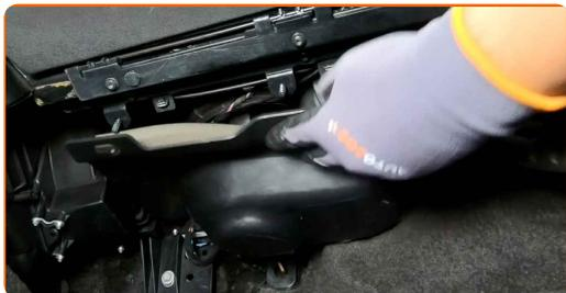
**12** Vissez les fixations du panneau latéral sous planche de bord du côté passager. Utilisez une douille n° 8. Utilisez une clé à cliquet.
