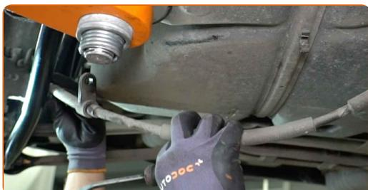
**10** Dévissez la fixation du câble de frein de stationnement. Utilisez une clé mixte de No.10
