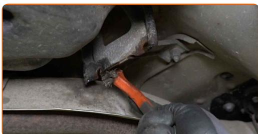
**19** Attachez le câble de frein à main sur le mécanisme de frein à main.
